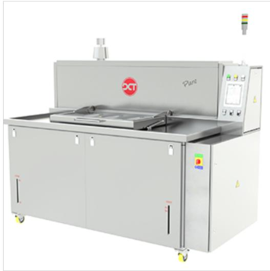
高压水清洗机用于机械零件的清洗效果明显：高压水清洗机常用于零件表面形状较复杂且有螺纹孔、盲孔、及窄缝隙状态的清洗及用其他清洗方法难于除去的硬质粘着微粒子的清洗。该清洗的特点是采用高于传统喷射压力，且选用专门喷嘴对工件做定点喷射。清洗度要求高的表面或较难清洁的部位采用高压水清洗，其余部位采用低压喷淋；清洗设备必须具有过滤除渣、油水分等能力。高压水清洗机一般采用循环过滤、液面吹吸等；降噪及性的要求，其中喷嘴的材质具有高耐磨性，高压喷淋聚有高可靠性、低噪性和密封性；零件要有可靠的装夹方式，可承受喷淋压力冲击；
